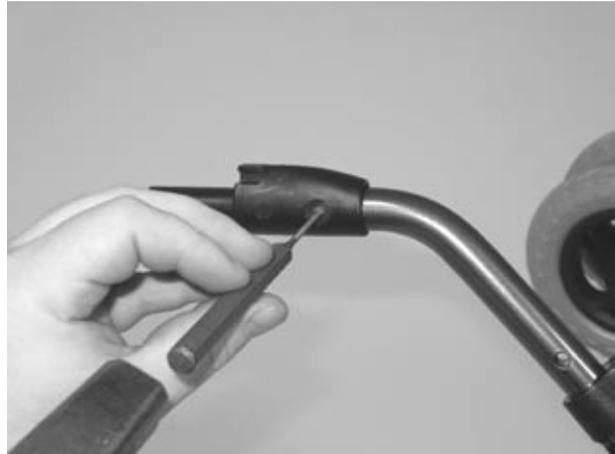
Drive the rivet into the anterior frame using a pin punch (Ø 4 mm).
